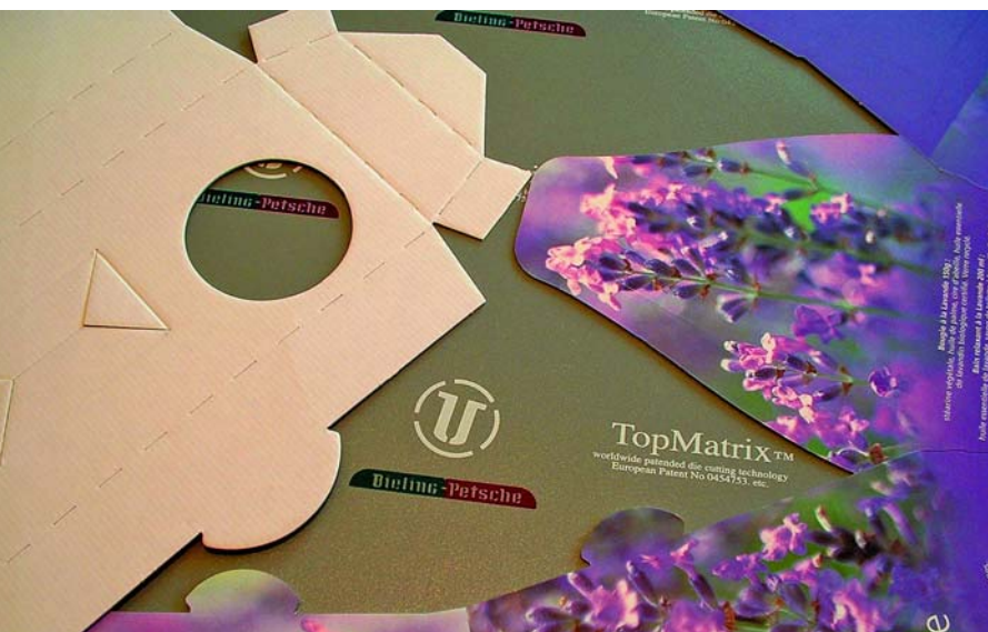
Saubere Schnittkanten erzeugen um 70 % weniger Stanzstaub - den Kunden freuts.
