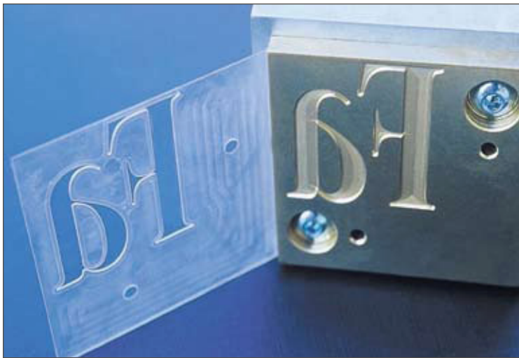
Zu den Hauptgeschäftsfeldern von Bieling & Petsche zählt der Stanzformenbau. Es werden aber auch Sonderlösungen wie Prägungen für die Blindenschrift angefertigt.
